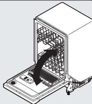
Tandis qu'une autre personne maintient le lave-vaisselle pour qu'il ne puisse basculer, effectuer plusieurs manœuvres d'ouverture et fermeture de la porte. Si la porte se ferme ou s'ouvre sous l'effet de son propre poids, il sera nécessaire d'effectuer un réglage de la tension des ressorts.
